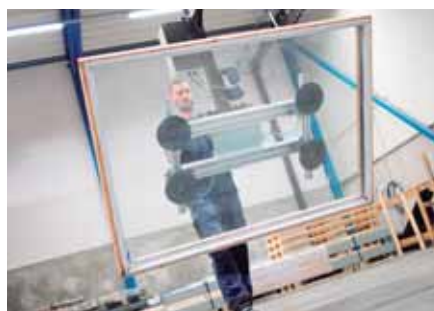
El número de ventosas se adapta a su carga para que el equipo sea siempre adecuado para sus necesidades de elevación. La función de liberación a dos manos garantiza un agarre y una liberación de la carga seguros y fáciles.
