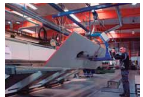
El agarre para chapas es ideal para manipular planchas de madera. Añada una función de inclinación y podrá inclinar fácilmente cargas de hasta 250 kilos, hasta 180 grados.
