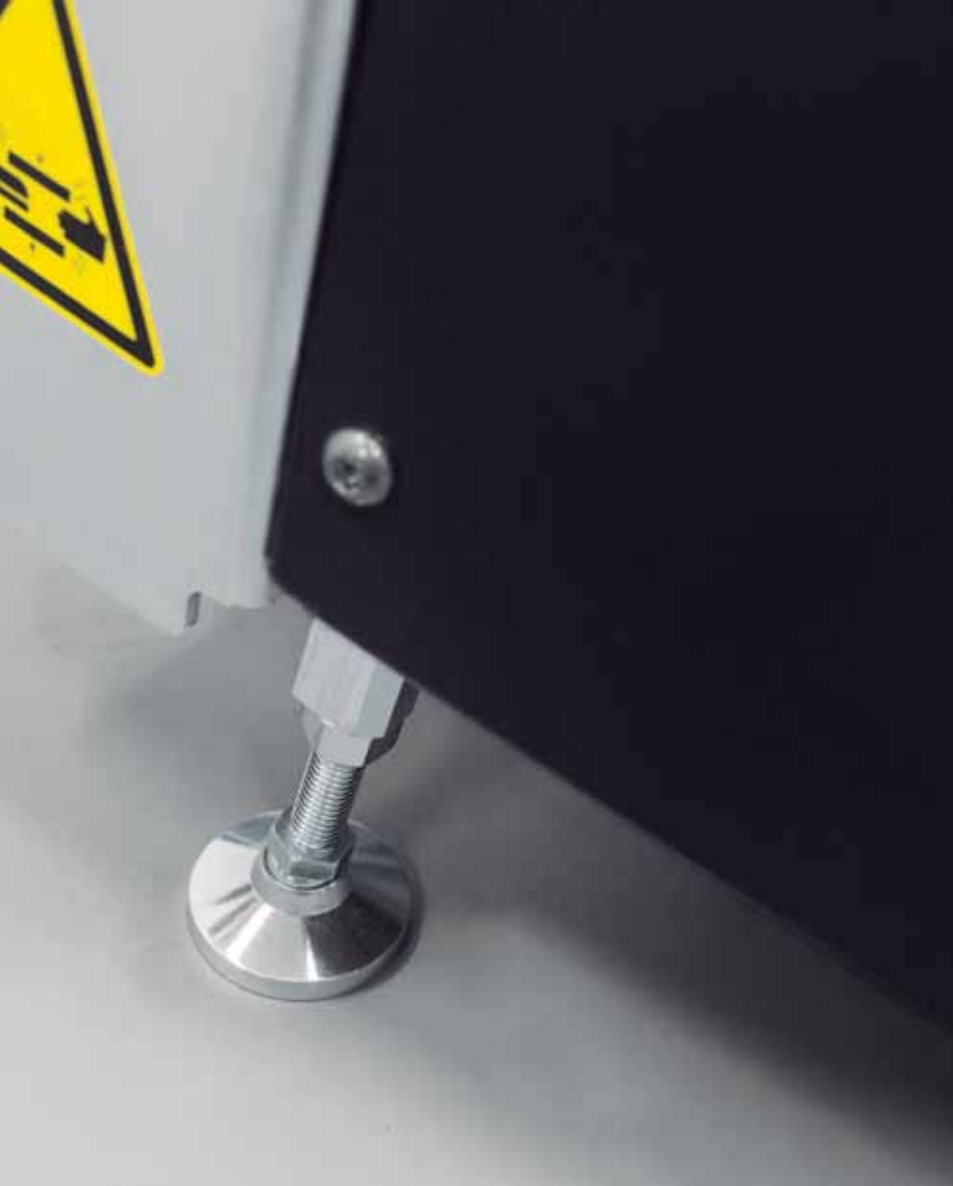
Las patas de apoyo se activan automáticamente cuando se pone en marcha la bomba
