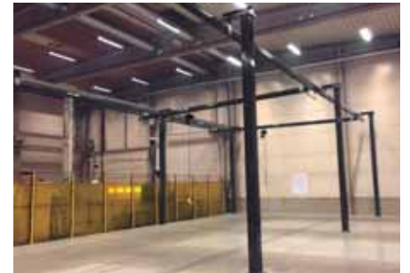
Nuestros perfiles de acero o aluminio pueden montarse en el techo o en los pilares, fabricados a la medida de sus instalaciones.
