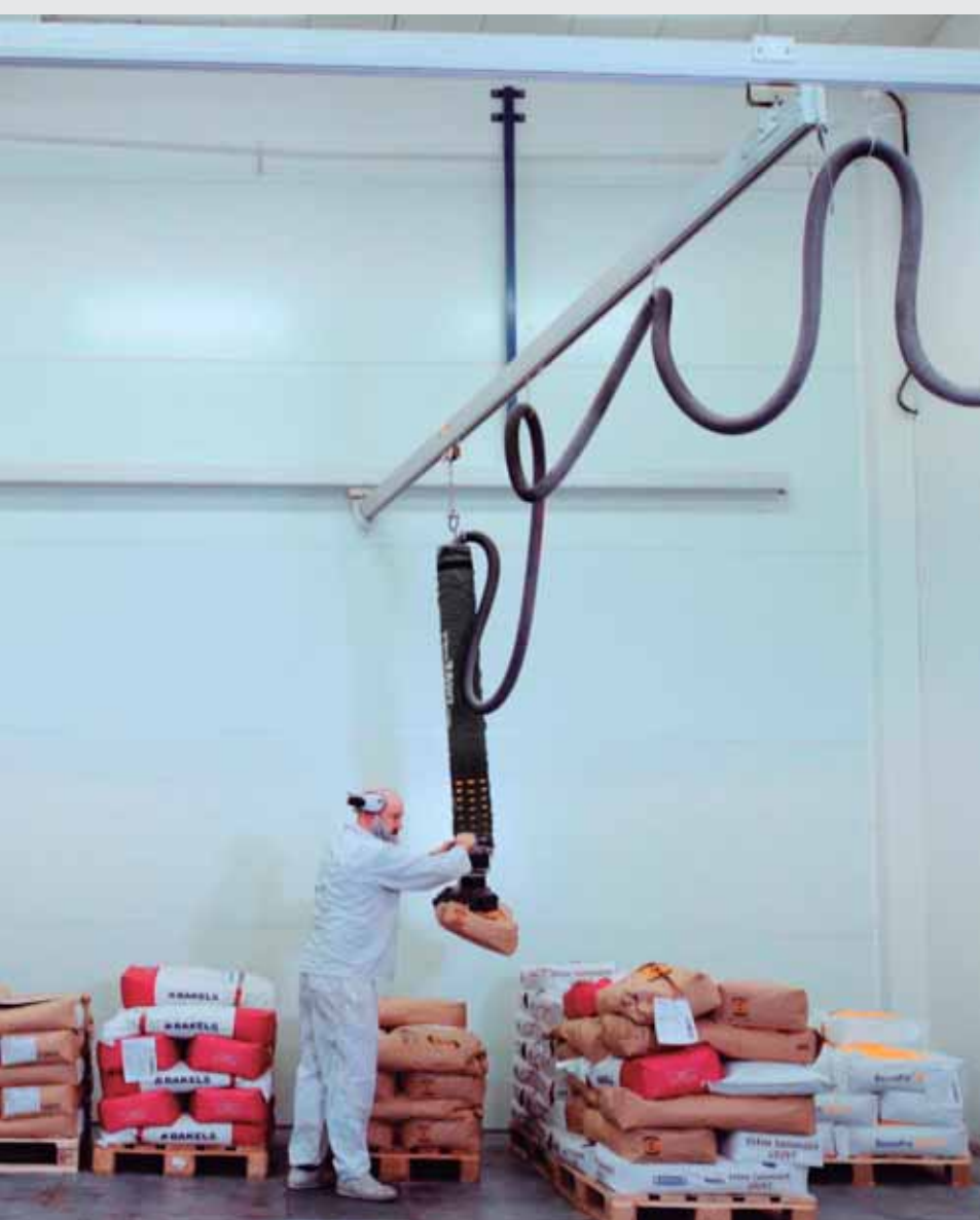
Los carros estables se mueven suavemente en los perfiles, desplazando de forma constante su elevador hasta donde lo necesite.
