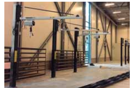
Los brazos pluma TAWI pueden montarse en la pared o en un pilar y hay opciones portátiles disponibles.
