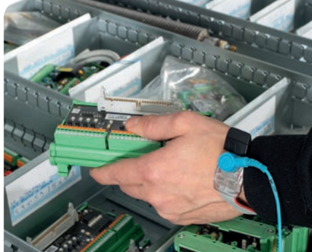
Sistema de protección ESD
