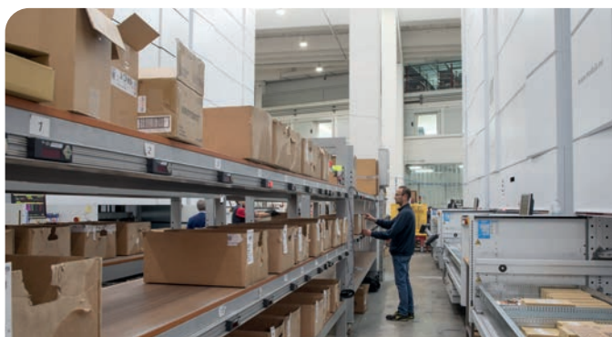
Sistemas Put to Light conectados al WMS
